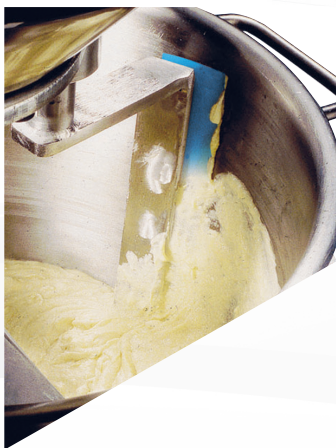
Patentierter Abstreifer für ein homogenes Vermischen aller Zutaten
