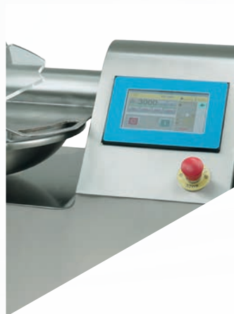
Ekran dotykowy 7" z cyfrowym wskaźnikiem prędkości obrotowej noża, temperatury, czasu, pozostałego czasu. Zmienna prędkość noża 750 - 3000 obr./min + 4 przyciski szybkiego wyboru
