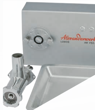
Zewnętrzna piasta napędu do higienicznego czyszczenia. Demontowalna gardziel do mielenia mięsa, np. do umieszczenia w chłodni.
